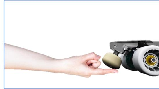
PARA EVITAR DAÑOS NO DESEADOS, NO HAY QUE LLEVAR EL FRENO DEMASIADO BAJO, YA QUE NO QUEDA SUFICIENTE ROSCA PARA AGUANTAR LAS FUERZAS QUE SE GENERAN.
